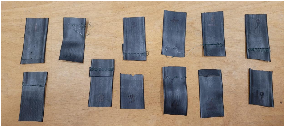
Foto van waar de teststukjes gebroken zijn
